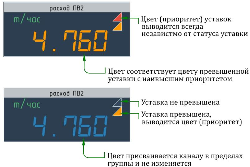
Рисунок 4.2 – Окно цифрового отсчёта в различных режимах индикации
